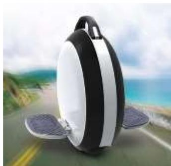
**Моноколесо** – тот же гироскутер, только с одним колесом. Балансом моноколеса управляют датчики наклона и гироскопы, расположенные в самом колесе. Главное условие, соблюдаемое при его управлении умение держать равновесие. Максимальная скорость до 15 км/час. Вес не превышает 10 кг.
